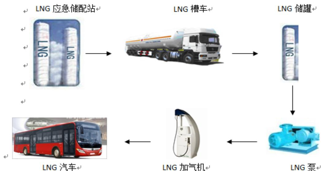
图 5-1 LNG 加气站工艺流程图
